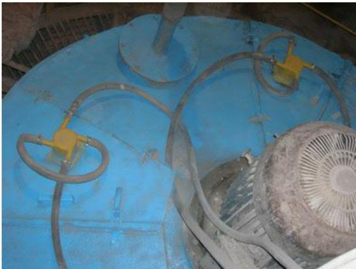
Рисунок 6 Установка форсунок в смесителе СБ-138Б.
