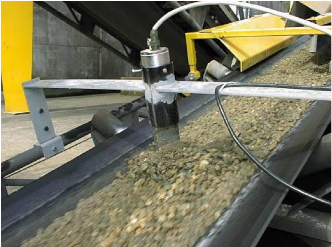
Рисунок 5 Датчик НР-Ш на транспортере
